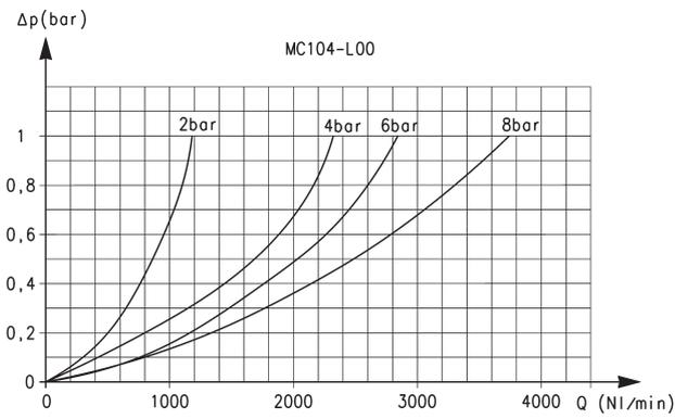
Diagramma di portata per i modelli: MC104-L00
