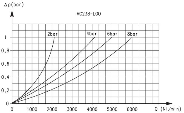
Diagramma di portata per i modelli: MC238-L00
