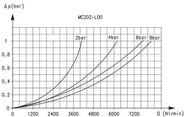
Diagramma di portata per i modelli: MC202-L00
